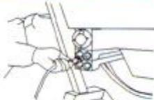
Assicurarsi che i tubi idraulici siano innestati in modo corretto rispettando il codice di riconoscimento a colori e ricordando che la loro inversione provoca movimenti opposti a quelli comandati.
